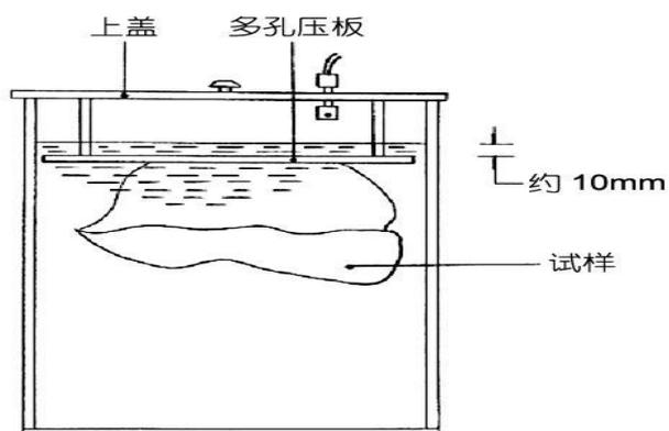
通過對真空室抽真空，使浸在水中的試樣產生內外壓差，觀測試樣內氣體外逸情況，以此判定試樣的密封性能；通過對真空室抽真空，使試樣產生內外壓差，觀測試樣膨脹及釋放真空後試樣形狀恢復情況，以此判定試樣的密封性能。
