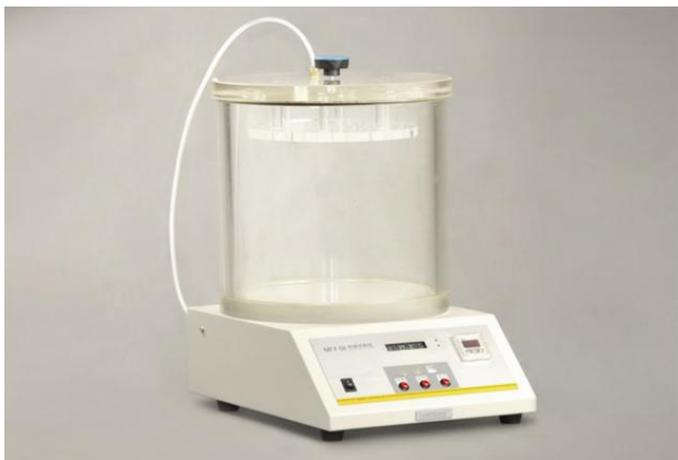
適用於食品、制藥、醫療器械、日化、汽車、電子元器件、文具等行業的包裝袋、瓶、管、罐、盒等的密封試驗。
